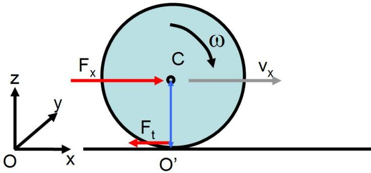
Figure 1: Une roue de rayon  $R_r$  roulant sans glisser en direction  $x$  sous l'influence d'une force  $F_x$  agissant sur son centre de masse  $C$ .
