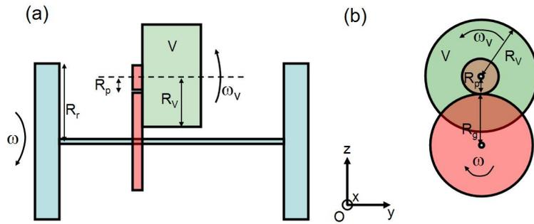
Figure 2: (a) Deux roues motrices (rayons  $R_r$ ) à droite et à gauche, et l'engrenage consistant en un grand disque (rayon  $R_g$ ) qui met en mouvement un petit disque (rayon  $R_p$ ). Le petit disque est sur le même axe que le volant d'inertie de rayon  $R_v$  et solidaire à celui-ci ; vue en direction  $-x$  (b) vue de l'engrenage en direction  $y$ .
